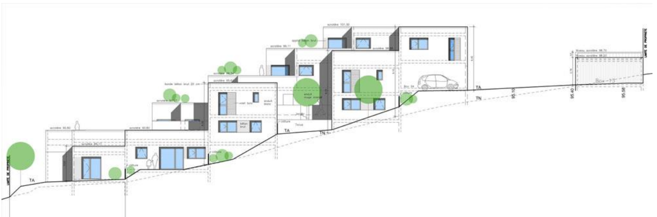
Exemple d'habitat intermédiaire intégré à la pente – Fabienne Gros Architecte – Atelier Gallois Architecte – AKOE – KEOPS – BAL & ACKERMANN
